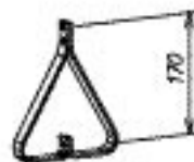
Triangle de suspension RÉF. : PSH/150/Z POIDS : 0,3 kg
