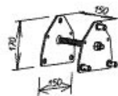
Vérin de fixation mural RÉF. : PVR/150/Z POIDS : 1,9 kg
